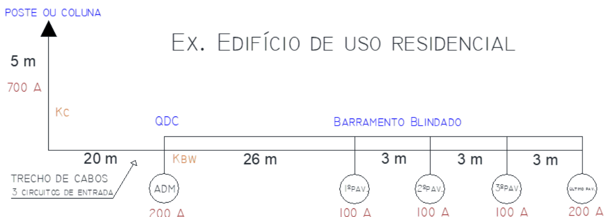
Figura 17 - Exemplo Edifício residencial -Rede de Distribuição Aérea
